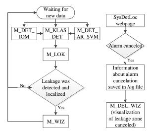
Fig. 8. Schemat działania systemu SysDetLog [21]
